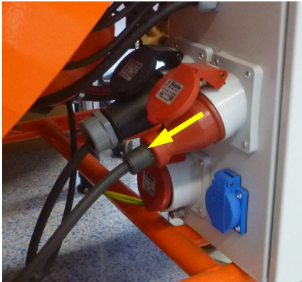
Abb. 4: Anschlusskabel entfernen
