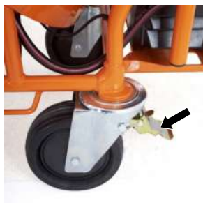
slika 29: Blokiranje parkirnih kotačića
