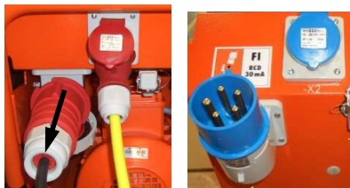
Sl. 81: Uklanjanje priključnog kabela
