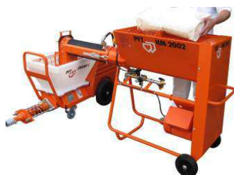
Sl. 37: Punjenje stroja SWING L materijalom
