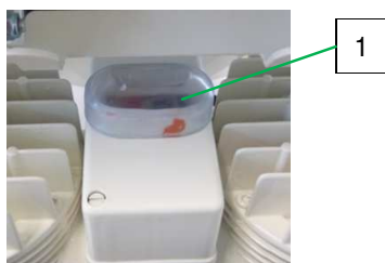
Fig. 51: Compresor de aire
