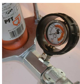
Fig. 36: Manómetro de presión de mortero
