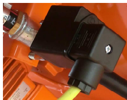
Fig. 92: Interruptor de presión del aire
