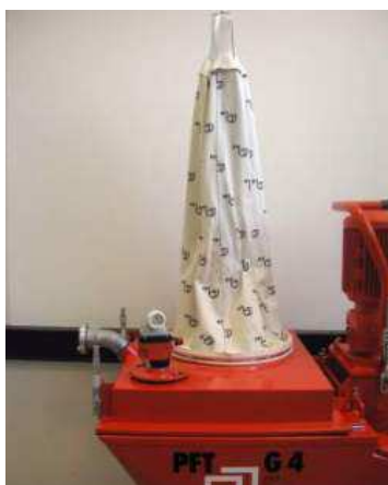
Fig. 40: Cubierta de alimentación
