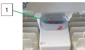
Fig. 57: Compresor de aire
