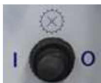
Fig. 67: Apagar la rueda de celdas
