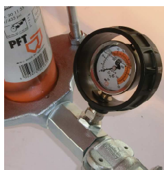
Fig. 20: Manómetro de presión de mortero
