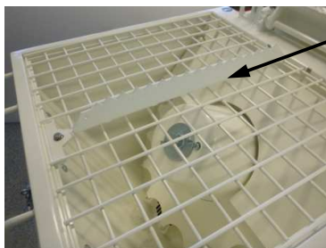
Fig. 24: Cubierta en forma de rejilla
