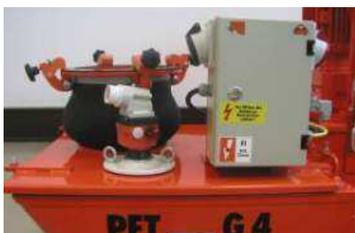
Fig. 41: Cubierta de descarga
