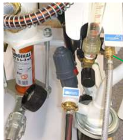
Fig. 49: Conectar la manguera de aire
