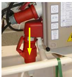
Fig. 85: Retirar el cable de conexión
