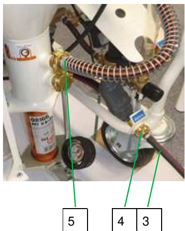
Fig. 29: Conexión del agua
