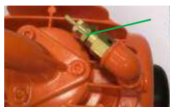
Fig. 93: Válvula de seguridad
