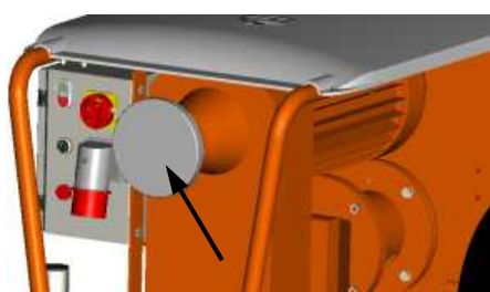
Fig. 32: Cambiare la velocità
