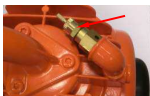
Fig. 73: Valvola di sicurezza
