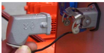
Fig. 40: Collegare la spina finta
