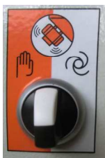
Fig. 16: Modalità operative vibratore
