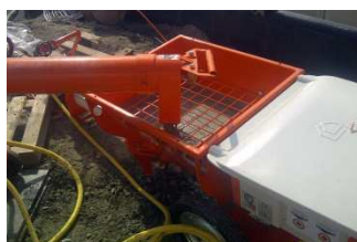
Fig. 30: Caricare il materiale nella ZP 3
