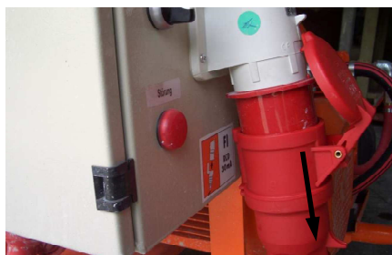
Fig. 70: Staccare il cavo di alimentazione
