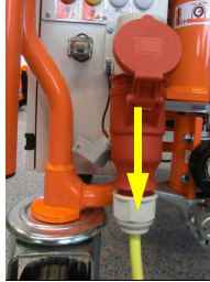
图 96: 取下连接电缆
