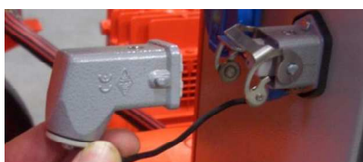
Fig. 17: Introducere fișă oarbă
