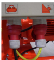
Fig. 23: Racordarea vibratorului și compresorului de aer
