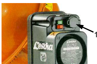
Fig. 26: Racordarea mixerului cu tambur
