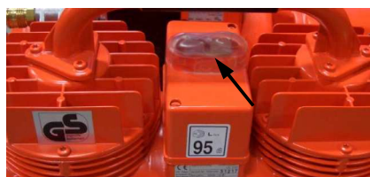
Fig. 36: Deschiderea robinetului de aer aparat de stropit
