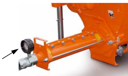
Fig. 49: Presiune mortar pe „0“
