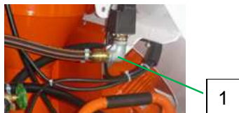
Рис. 54: Подключение воздушного шланга
