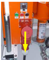
Рис. 92: Удаление соединительного кабеля
