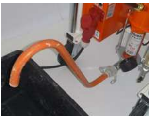
Рис. 47: Труба для контроля консистенции раствора
