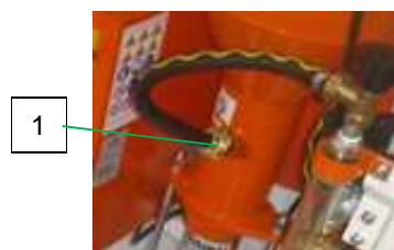
Рис. 36: Снятие водяного шланга
