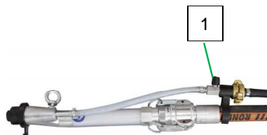
Рис. 60: Закрывание воздушного крана
