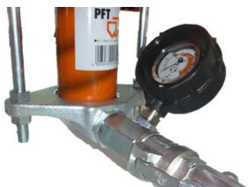
Рис. 42: Манометр давления раствора
