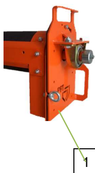
Рис. 40: Ослабить рым-гайку
