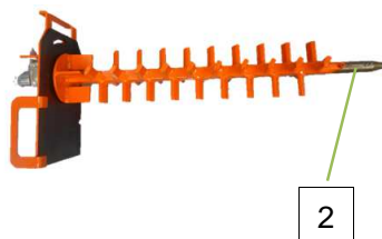
Рис. 42: Очистить месильный вал
