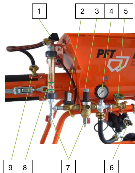
Рис. 7: Водопроводная арматура с насосом для поддержания давления
