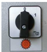
Rys. 76: Wyłączenie koła dozującego
