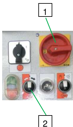
Rys. 68: Ustawić przełącznik główny w pozycji „OFF“
