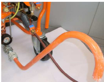
Rys. 50: Rurka do badania konsystencji zaprawy
