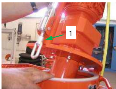
Fig. 57: Chiudere la flangia del motore
