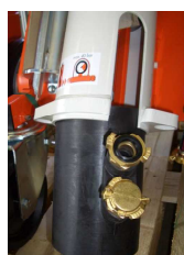
Fig. 60: Pulizia della zona di miscelazione in gomma
