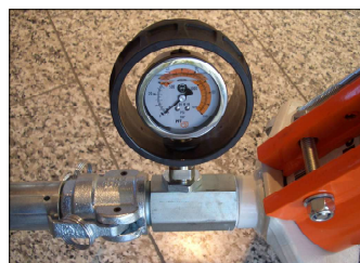
Fig. 73: Pressione della malta su “0 bar”.
