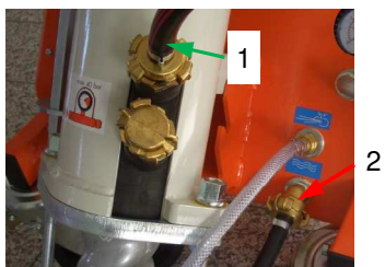
Fig. 63: Scollegamento dell'alimentazione dell'acqua
