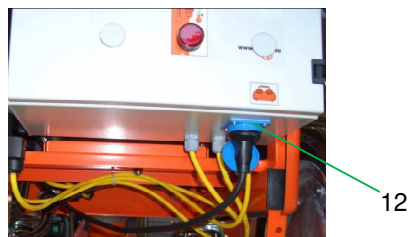
Fig. 12: Collegamenti quadro elettrico
