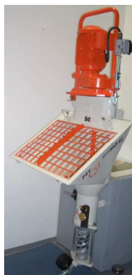
Fig. 22: Unità pompa impastatrice
