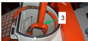
Fig. 64: Rimuovere il miscelatore
