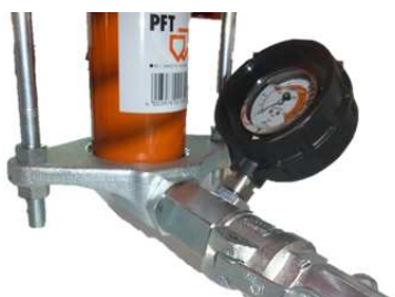
图 41: 砂浆压力计
