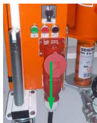
图 91：取下连接电缆
