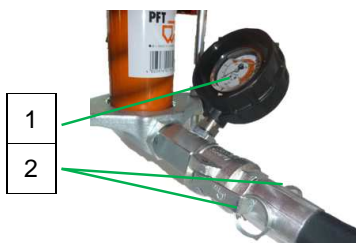
图 73：砂浆压力为“0”bar
