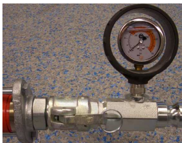
Рис. 24: Подключение манометра давления раствора.
