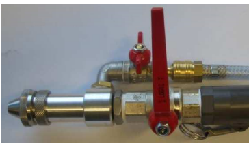
Рис. 18: Манометр давления раствора / растворный пистолет
