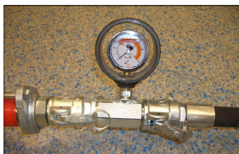
Рис. 16: Манометр давления раствора
