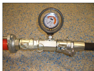
Рис. 47: Манометр давления раствора
