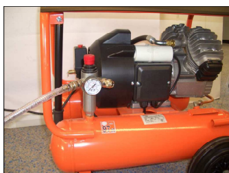
Рис. 30: Подключение воздушного шланга
