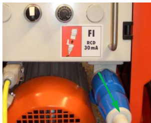
Рис. 50: Извлечение соединительного кабеля
