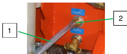
图 55: 连接空气软管
