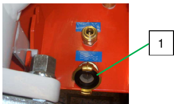
图 100: 入水口内的集污筛网
