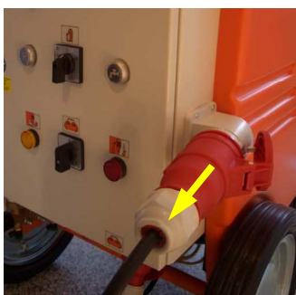
图 97：取下连接电缆
