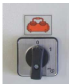
图 60: 关断空气压缩机
