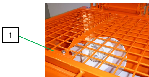
Illustration 4 : Dépose de la grille de protection
