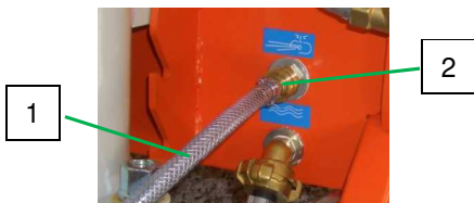
55. ábra: A levegőtömlő csatlakoztatása
