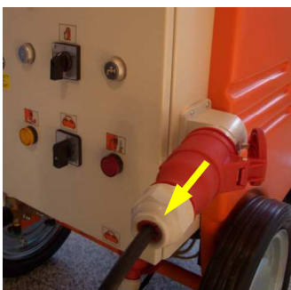
97. ábra: Csatlakozókábel eltávolítása
