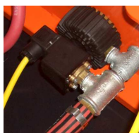
Рис. 99: Мембранный выключатель по воде
