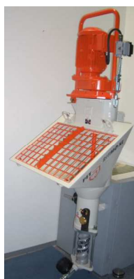
Рис. 27: Узел смесительного насоса
