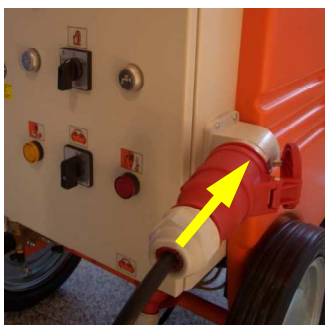
Рис. 29: Подключение электропитания
