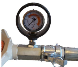
Рис. 1: Манометр давления раствора
