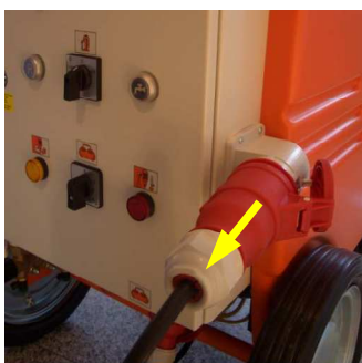
Рис. 94: Извлечение соединительного кабеля
