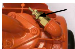
Рис. 101: Предохранительный клапан
