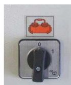
Рис. 56: Отключение воздушного компрессора
