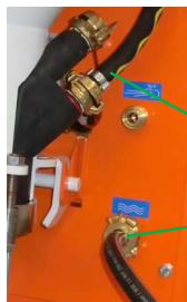
Рис. 110: Присоединение воздушного рукава
