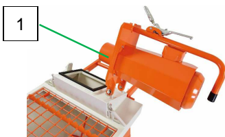
Рис. 30: Закрывание откидывающегося фланца
