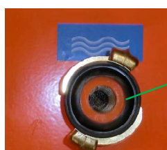
Рис. 114: Грязеулавливающий фильтр во входе воды
