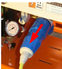
Рис. 112: Демонтаж соединительного кабеля
