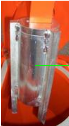
Abb. 80: Mischrohrreiniger einsetzen
