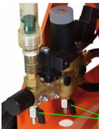
Abb. 72: Ablasshähne öffnen
