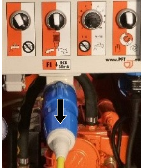
Abb. 95: Anschlusskabel entfernen
