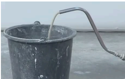
Abb. 55: Konsistenzprüfrohr
