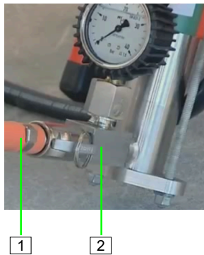
Abb. 44: Mörtelschlauch anschließen
