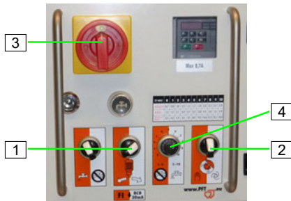
Abb. 69: Maschine nach Stromausfall einschalten
