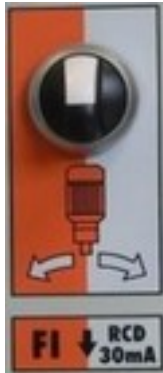
Abb. 20: Wahlschalter Pumpenmotor
