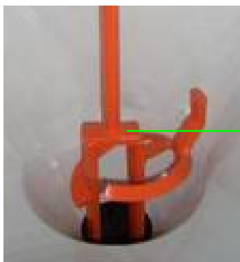
Abb. 71: Mischwendel entnehmen
