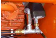
Fig. 89: Pressostato compressore aria
