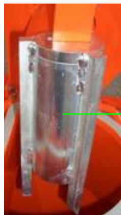
ilustracja 83: Wkładanie urządzenia do czyszczenia rury mieszalnej
