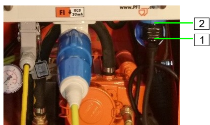
ilustracja 50: Włączanie sprężarki powietrza
