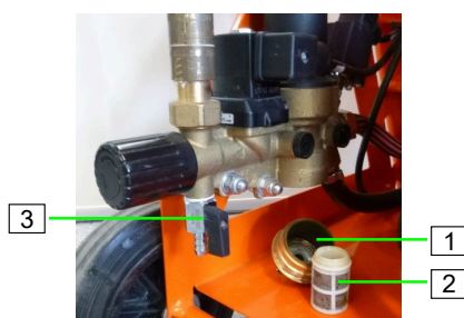
ilustracja 36: Kontrola sita osadnika zanieczyszczeń
