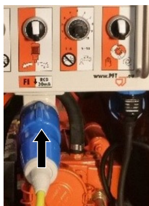
ilustracja 33: Podłączenie zasilania elektrycznego
