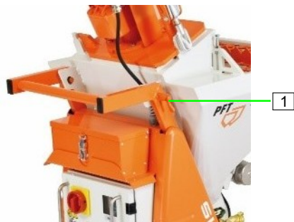
ilustracja 7: Otwieranie rygla obrotowych
