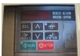
ilustracja 91: Elementy sygnalizujące usterki
