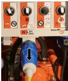
ilustracja 96: Odłączanie kabla zasilającego
