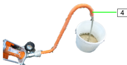
ilustracja 58: Sprawdzenie konsystencji
