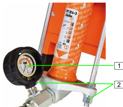
ilustracja 93: Kontrola ciśnienia zaprawy
