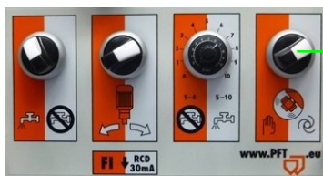
ilustracja 52: Włączanie wibratora
