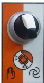
ilustracja 23: Przełącznik wibratora
