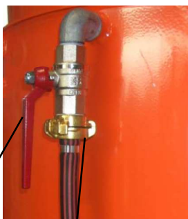
39 pav.: vandens tiekimo atjungimas
