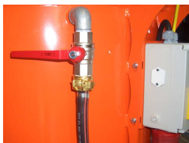
26 pav.: vandens tiekimo prijungimas
