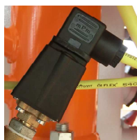
Fig. 91: Interruptor de pressão de água
