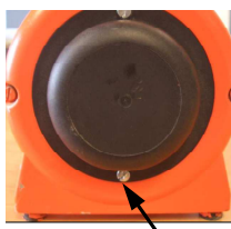
Fig. 88: Abrir a cobertura do filtro
