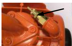
Fig. 93: Válvula de segurança
