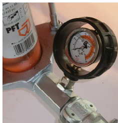
Fig. 20: Manómetro de pressão para argamassa
