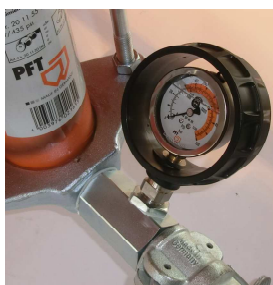
Fig. 36: Manómetro de pressão para argamassa
