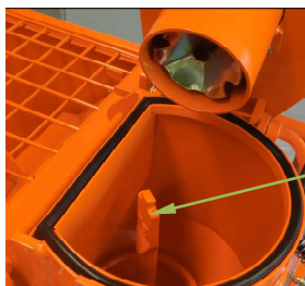
Fig. 73: Abrir a flange do compensador do motor
