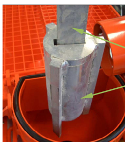
Fig. 74: Introduzir o limpador do tubo de mistura
