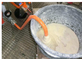
Fig. 44: Consistência de argamassa
