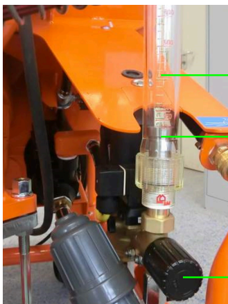
Kuva 37: Vesimäärän asettaminen
