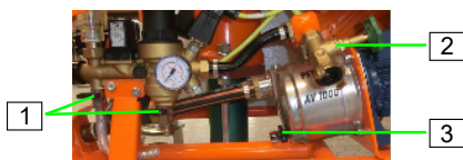
Kuva 31: Tyhjennysventtiilien sulkeminen
