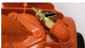
Kuva 90: Varoventtiili
