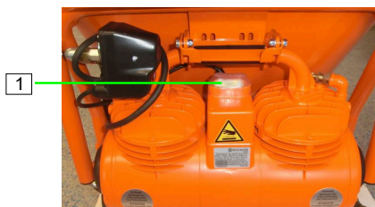
Kuva 57: Ilmakompressorin sammuttaminen
