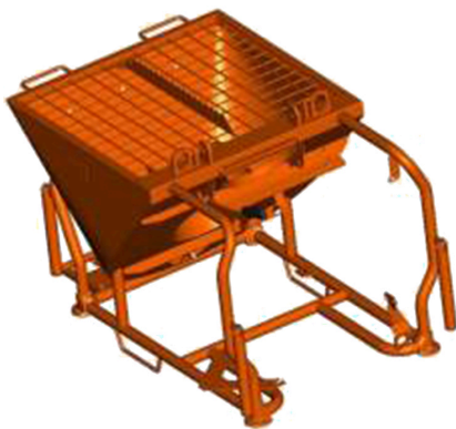
Kuva 11: Materiaalisäiliön rakenneryhmä
