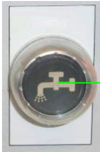
Kuva 36: Vedensyöttöpainikkeen painaminen
