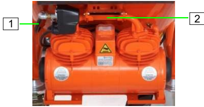
Kuva 83: Ilmakompressorin irrotus
