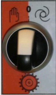
Kuva 18: Siipipyörän valintakytkin
