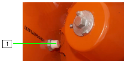
Kuva 24: Täyttötasoanturi materiaali-säiliössä
