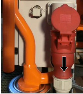
Kuva 82: Liitäntäjohdon poistaminen
