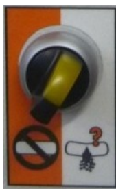
Kuva 20: Täyttötasoanturin valintakytkin
