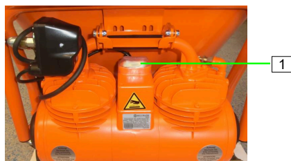
Kuva 44: Ilmakompressorin käynnistäminen
