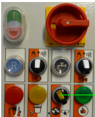
Kuva 66: Täyttötasoanturin poistaminen käytöstä
