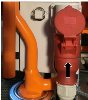
Kuva 29: Virransyötön liittäminen
