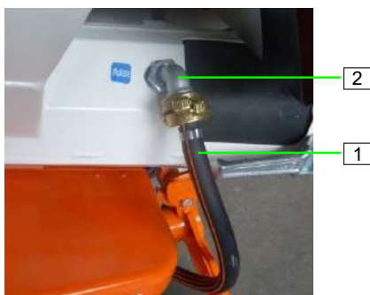
Abb. 93: Wasserschlauch anschließen
