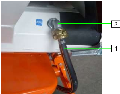
Abb. 43: Wasserschlauch abnehmen
