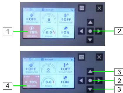
Abb. 53: Pumpenmotor einstellen
