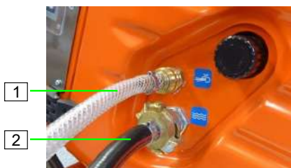
Abb. 88: Wasserschlauch abnehmen
