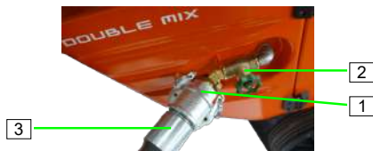
Abb. 62: Mörtelschläuche vorbereiten
