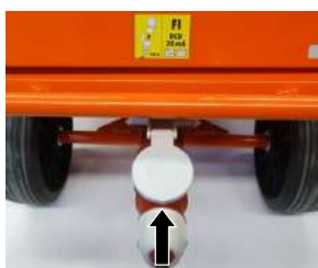
Abb. 32: Stromversorgung anschließen
