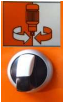
Abb. 23: Wahlschalter Pumpenmotor
