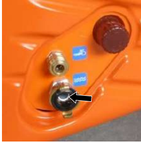
Abb. 130: Schmutzfängersieb im Wassereinlauf
