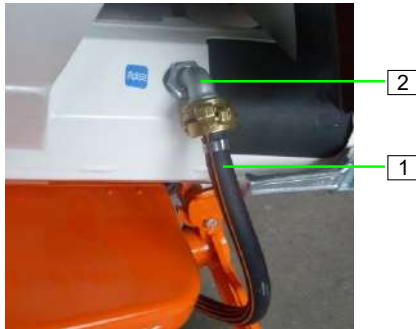
Abb. 110: Wasserschlauch anschließen
