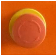
Abb. 26: NOT-HALT/NOT-AUS-Taster
