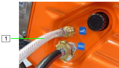
Abb. 65: Luftschlauch anschließen
