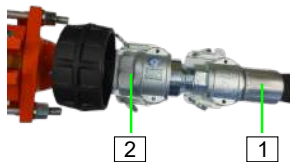
Abb. 63: Mörtelschlauch anschließen
