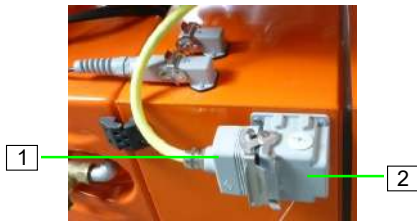
Abb. 33: Motoranschlusskabel anschließen
