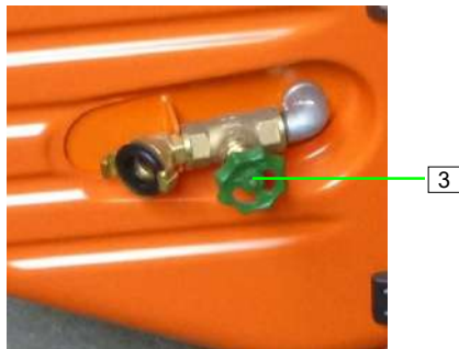
Abb. 37: Wasserentnahmeventil schließen
