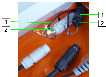
Abb. 102: Steckverbindungen verschließen
