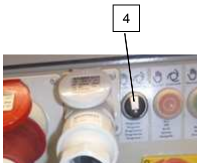
Rys. 31: Tryb manualny - „0” - tryb automatyczny
