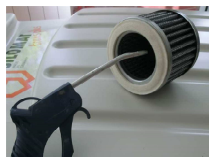
Rys. 46: Czyszczenie wkładów filtrów
