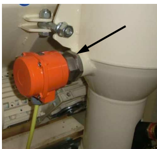
Fig. 26: Sensore di livello nel tubo di miscelazione
