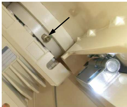
Fig. 99: Lubrificare il motoriduttore
