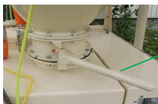
Fig. 43: Aprire lo sportello del silos
