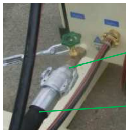
Fig. 49: Allestimento del flessibile per malta
