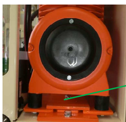
Fig. 95: Estrarre il compressore d'aria
