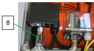
Fig. 61: Interruttore di disattivazione del rubinetto a sfera
