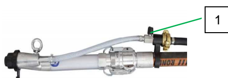
Fig. 57: Chiusura del rubinetto dell'aria
