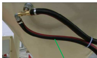
Fig. 51: Collegamento del flessibile per aria
