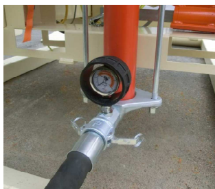
Fig. 16: Manometri a pressostato per malta
