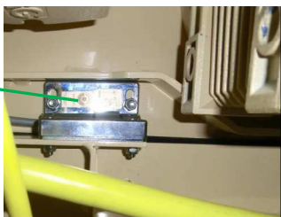
Fig. 23: Cerniera - interruttore di sicurezza
