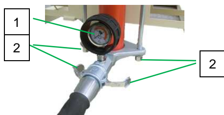
Fig. 67: Manometri a pressostato per malta
