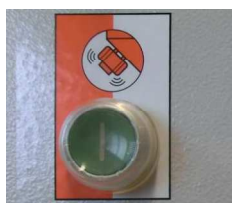
Fig. 44: Accendere il vibratore
