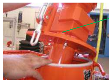
Fig. 79: Chiusura della flangia di ribaltamento del motore
