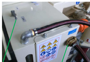
Fig. 51: Collegamento del flessibile per aria
