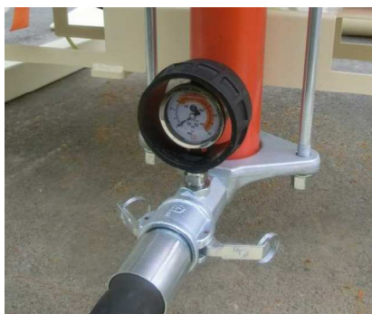
Fig. 41: Manometri a pressostato per malta
