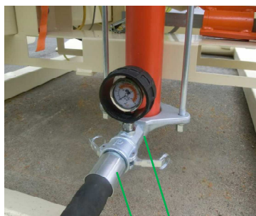
Fig. 50: Collegamento del flessibile per malta
