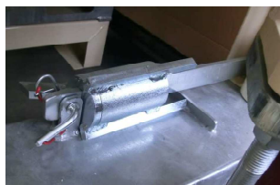
Fig. 78: Pulitore del tubo di miscelazione
