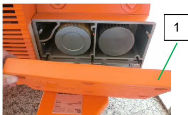
Abb. 45: Filterdeckel lösen
