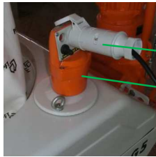
Abb. 19: Steuerkabel anschließen
