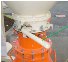
Abb. 30: Siloauslaufklappe schließen
