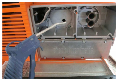
Abb. 48: Filtergehäuse reinigen
