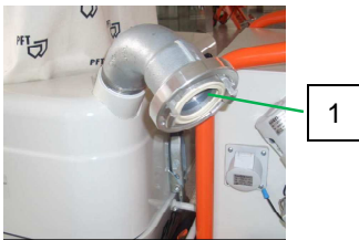
Abb. 16: Förderschlauch anschließen
