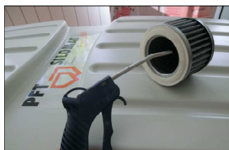
Abb. 47: Filterpatronen reinigen
