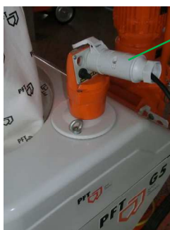
Abb. 34: Steuerstecker abziehen
