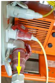
Abb. 28: Stromzufuhr unterbrechen
