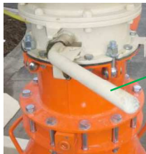
Abb. 37: Siloauslaufklappe schließen
