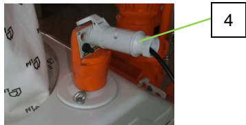
20. ábra: Vezérlőkábel csatlakoztatása
