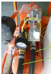
17. ábra: Tömlők csatlakoztatása
