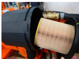
47. ábra: A szűrőfedél lecsavarozása
