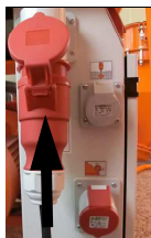
14. ábra: Áramellátás csatlakoztatása
