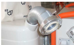
16. ábra: A szállítóvezeték csatlakoztatása
