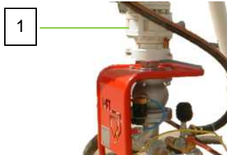
Abb. 42: Siloauslaufklappe schließen
