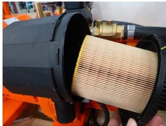
Abb. 47: Filterdeckel abschrauben
