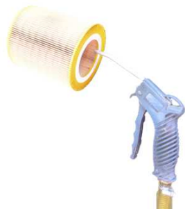
Abb. 48: Filterpatrone ausblasen
