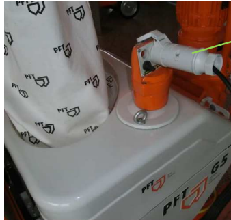
Abb. 39: Steuerstecker abziehen
