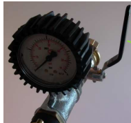
Abb. 18 Anschluss Luftschlauch
