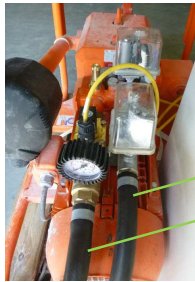
Abb. 17: Schläuche anschließen
