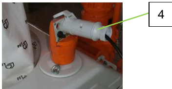
Abb. 20: Steuerkabel anschließen
