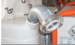
Abb. 16: Förderleitung anschließen
