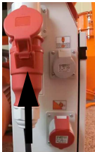
Abb. 14: Stromversorgung anschließen
