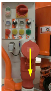
Рис. 93: Удаление соединительного кабеля
