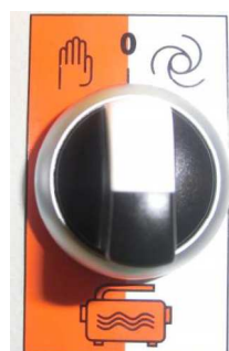
Рис. 13: Режимы эксплуатации водяного насоса
