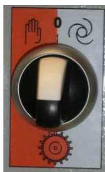
Рис. 12: Режимы эксплуатации подающего барабана
