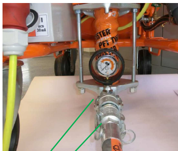
Рис. 51: Подключение шланга для подачи раствора
