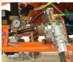
Рис. 50: Подготовка шланга для подачи раствора
