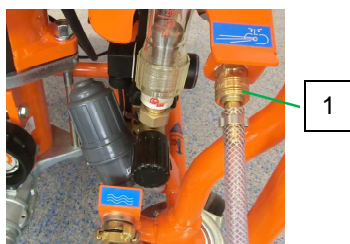
Рис. 53: Подключение воздушного шланга
