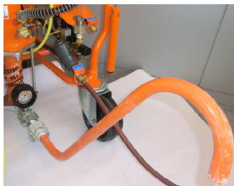
图 48：稠度检测管
