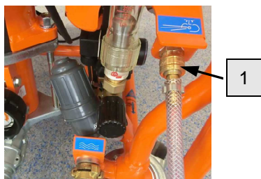
图 55：连接空气软管
