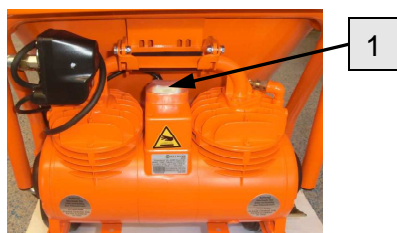
图 57：空气压缩机
