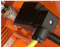
图 102：空气的压力开关
