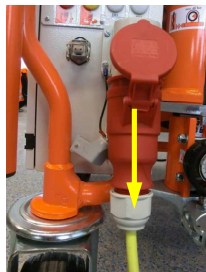
图 95：取下连接电缆
