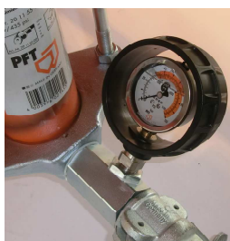
图 26：砂浆压力计
