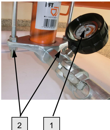
图 67：检查砂浆压力
