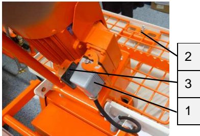
Kuva 91: Moottorin kallistuslaipan avaaminen
