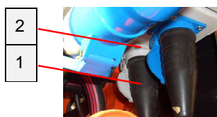
Kuva 59: Täryttimen liittäminen
