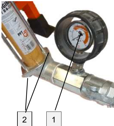
Kuva 75: Laastipaineen tarkastaminen
