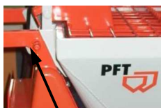
Kuva 31: Kääntösalkan avaaminen
