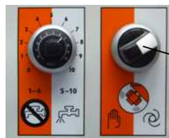
Kuva 60: Täräytimen käynnistäminen
