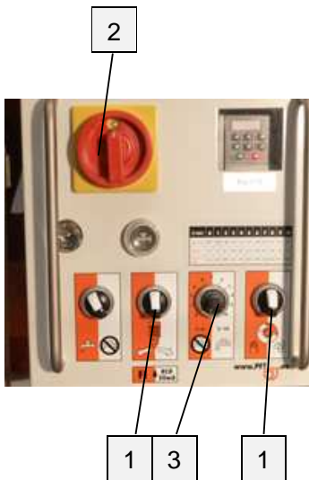
Kuva 76: Alijännitelaukaisin
