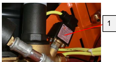
Kuva 115: Painekeytkin
