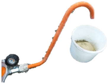
Afbeelding 56: Consistentiecontrolebuis
