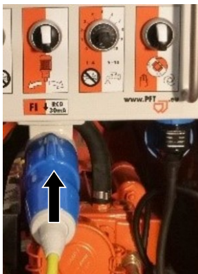
Afbeelding 33: Stroomvoorziening aansluiten
