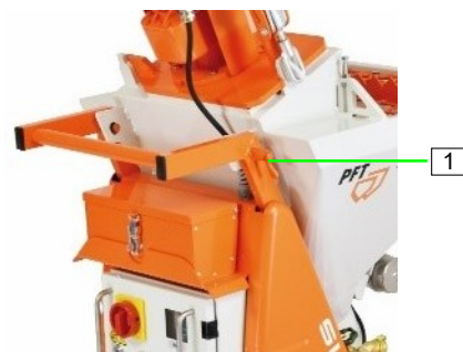
Afbeelding 7: Draaigrendel openen
