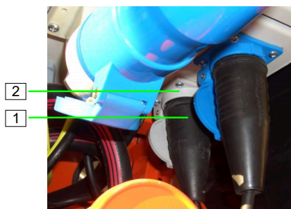
Afbeelding 51: Schudder aansluiten
