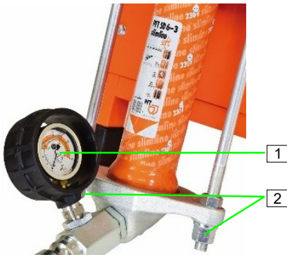
Afbeelding 93: Morteldruk controleren
