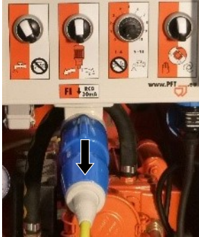
Afbeelding 96: Aansluitkabel verwijderen
