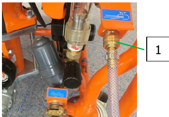
ภาพ 59: เชื่อมต่อท่ออากาศ
