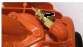
Figure 90 : Soupape de sécurité
