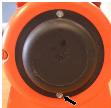
Figure 85 : Ouverture du couvercle du filtre
