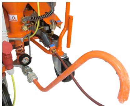
Figure 48 : Tube de contrôle de consistance
