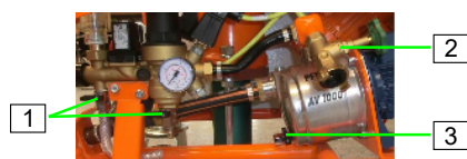
Figure 31 : Fermer les robinets de vidange
