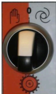
Figure 18 : Sélecteur du rotor alvéolaire
