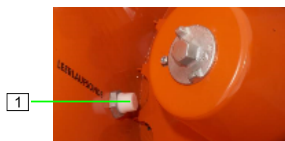
Figure 24 : Capteur de niveau dans le réservoir de matériau
