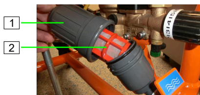
Figure 86 : Filtre en plastique
