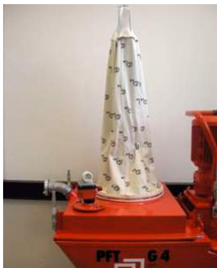
Figure 47 : Capot d'injection
