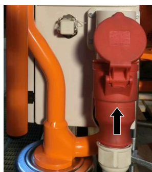
Figure 29 : Raccorder l'alimentation électrique
