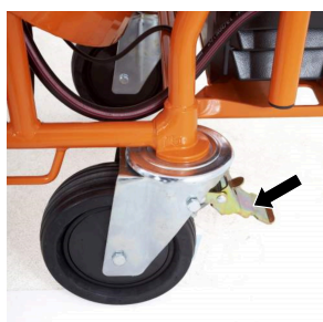
Figure 28 : Bloquer la roulette verrouillable
