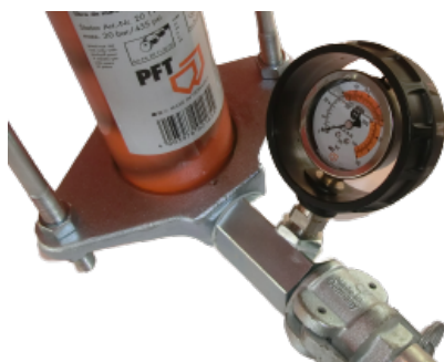
Figure 16 : Manomètre de pression du mortier
