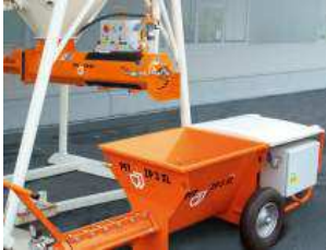
Kuva 32: Materiaalin syöttäminen ZP 3 -koneeseen
