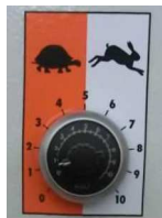
Kuva 17: Pumppumoottorin kierrosluvunsäädin
