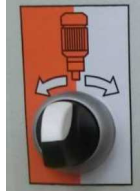
Kuva 16: Pumppumoottorin käyttötavat
