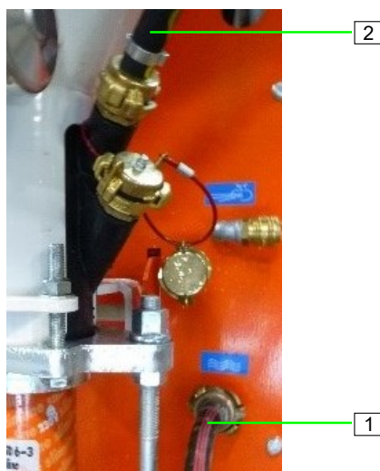
Figura 73: Separazione dell'alimentazione dell'acqua
