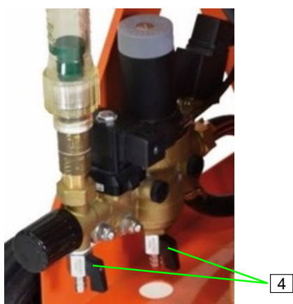
Figura 75: Aprire i rubinetti di scarico
