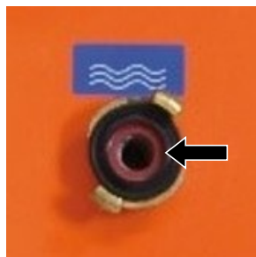
Figura 97: Tamiz de suciedad en la toma de agua
