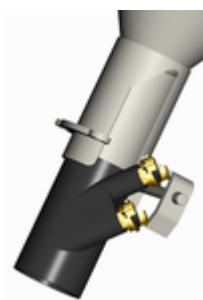
Figura 88: Limpiar la zona de mezcla de goma
