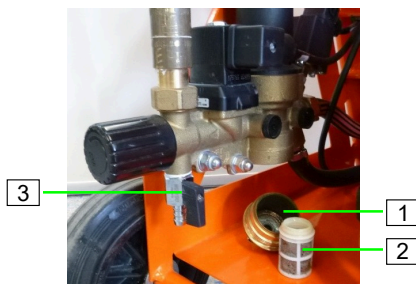
Figura 36: Verifique el tamiz de suciedad
