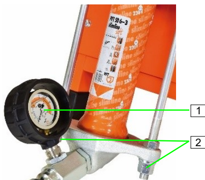
Figura 93: Verifique a pressão da argamassa
