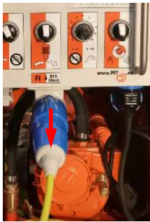
图 118：取下连接电缆
