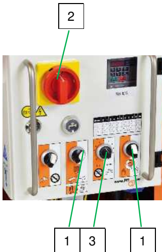
图 89: 欠压触发器
