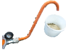
图 63: 稠度检测管
