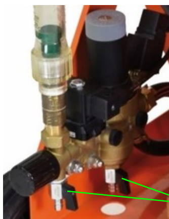
Afbeelding 75: Aftapkranen openen
