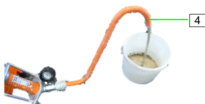
Afbeelding 58: Consistentie controleren
