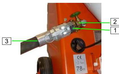
Afbeelding 45: Mortelslangen voorbereiden
