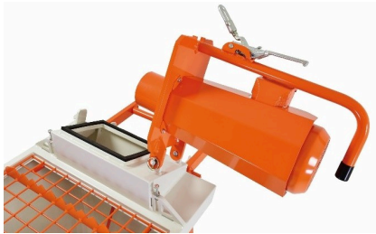
Afbeelding 5: Motorkantelflens sluiten
