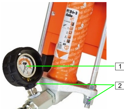
Afbeelding 71: Morteldruk controleren en afbouwen
