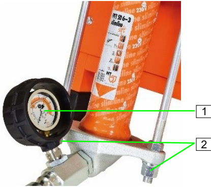
Afbeelding 93: Morteldruk controleren
