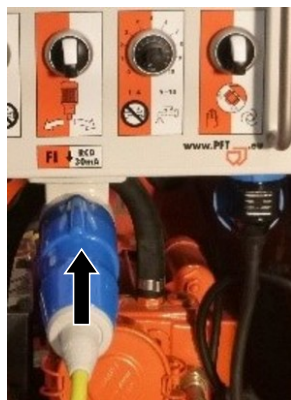
Afbeelding 33: Stroomvoorziening aansluiten
