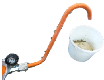
Afbeelding 56: Consistentiecontrolebuis
