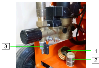
Afbeelding 36: Vuilvangzeef controleren
