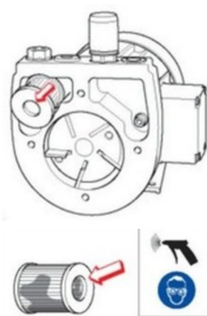
Abb. 105: Filter druchblasen
