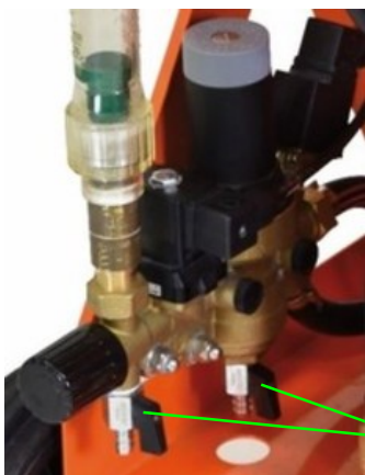
Abb. 75: Ablasshähne öffnen
