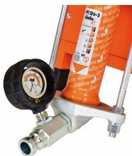
Abb. 19: Mörteldruckmanometer
