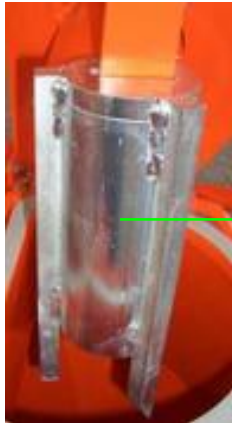
Abb. 83: Mischrohrreiniger einsetzen
