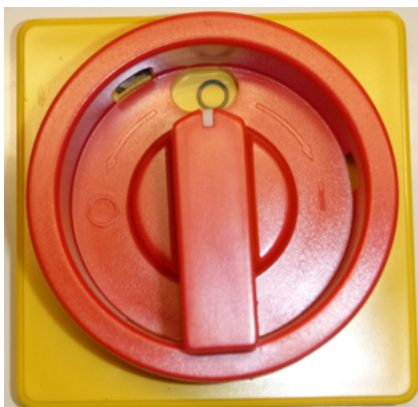
Abb. 70: Hauptschalter auf Stellung "0"
