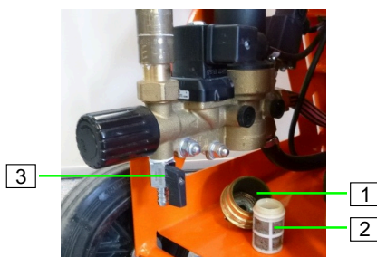
Abb. 36: Schmutzfängersieb prüfen
