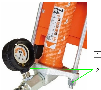
Abb. 71: Mörteldruck überprüfen und ablassen
