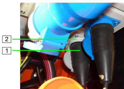
Abb. 51: Rüttler anschließen
