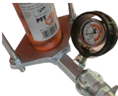
Figura 17: Medidor de pressão de argamassa
