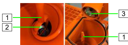
Figura 80: Inserir bobina de mistura
