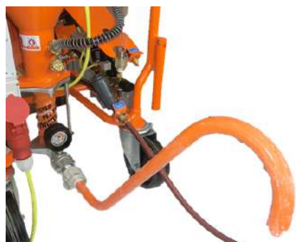
Figura 53: Tubo de teste de consistência
