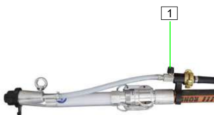
Pav. 59: Gaisa vārsta aizvēršana
