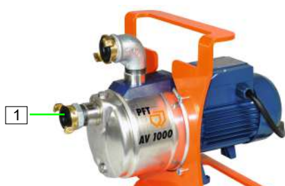
Pav. 50: Sūkņa piepildīšana
