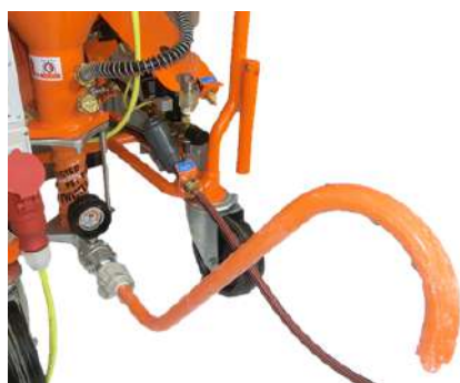
Pav. 53: Konsistences pārbaudes caurule
