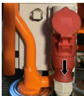
Pav. 86: Pieslēguma vada noņemšana
