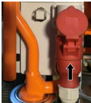
Pav. 30: Elektroapgādes pieslēgšana
