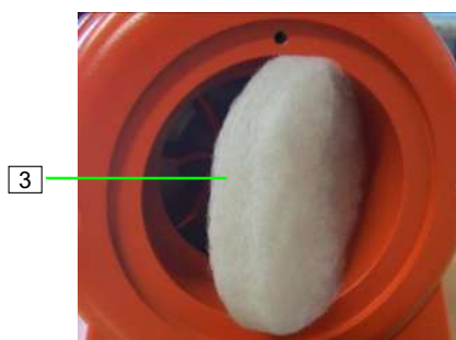
Pav. 88: Gaisa kompresora filtrs
