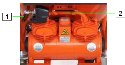
Pav. 87: Gaisa kompresora izņemšana
