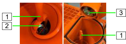
Pav. 80: Maisīšanas spirāles ievietošana
