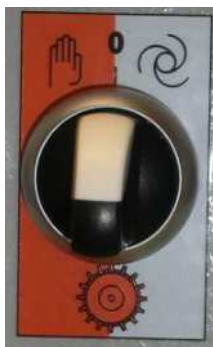
ภาพ 12: รูปแบบการทำงานของวาล์วหมุน
