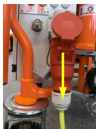
ภาพ 95: ถอดสายเคเบิลเชื่อมต่อออก
