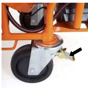
Slika 29: Fiksiranje zavornega kolesa
