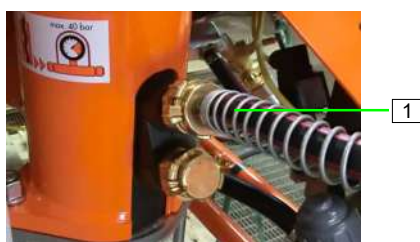
Slika 75: Priključitev cevi za vodo
