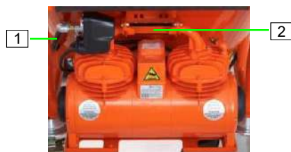
Slika 87: Odstranitev zračnega kompresorja
