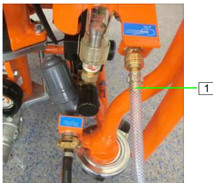
Slika 44: Priklučitev cevi za zrak
