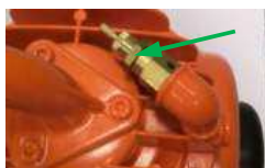
Kuva 103: Varoventtiili
