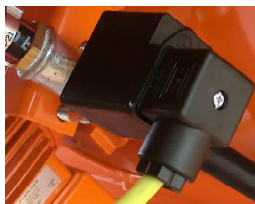
Kuva 102: Ilman painekeytkin
