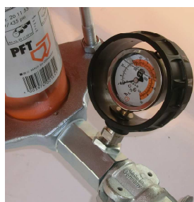
Kuva 42: Laastipainemittari
