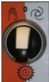
Ábra 19: Cellakerék választókapcsolója
