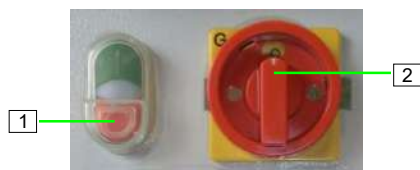
Ábra 63: A gép kikapcsolása
