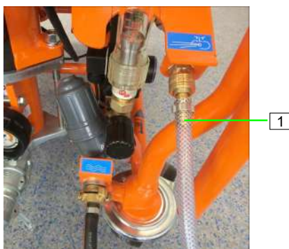
Ábra 44: A levegőtömlő csatlakoztatása
