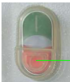
Ábra 61: A gép kikapcsolása
