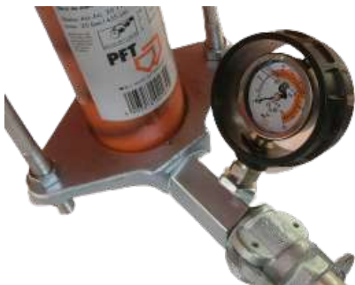
Ábra 27: Habarcsnyomásmérő
