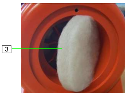
Ábra 88: A légkompresszor szűrője
