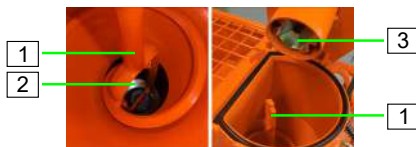
Ábra 80: A keverőcsiga behelyezése
