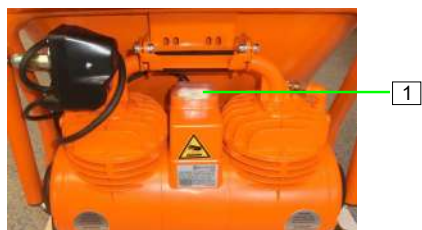
Ábra 46: A légkompresszor bekapcsolása
