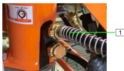
Figura 75: Racordarea furtunului de apă
