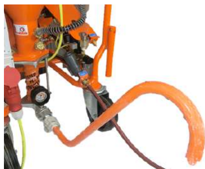
Figura 53: Țeavă de verificare a consistenței
