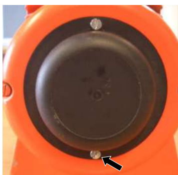
Figura 89: Deschidere capac filtru
