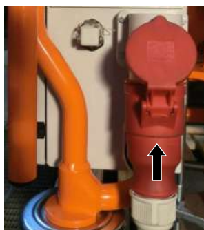
Figura 30: Racordarea tensiunii de alimentare
