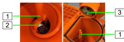
Figura 80: Montarea axului de amestecare
