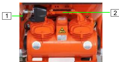
Figura 87: Scoaterea compresorului de aer
